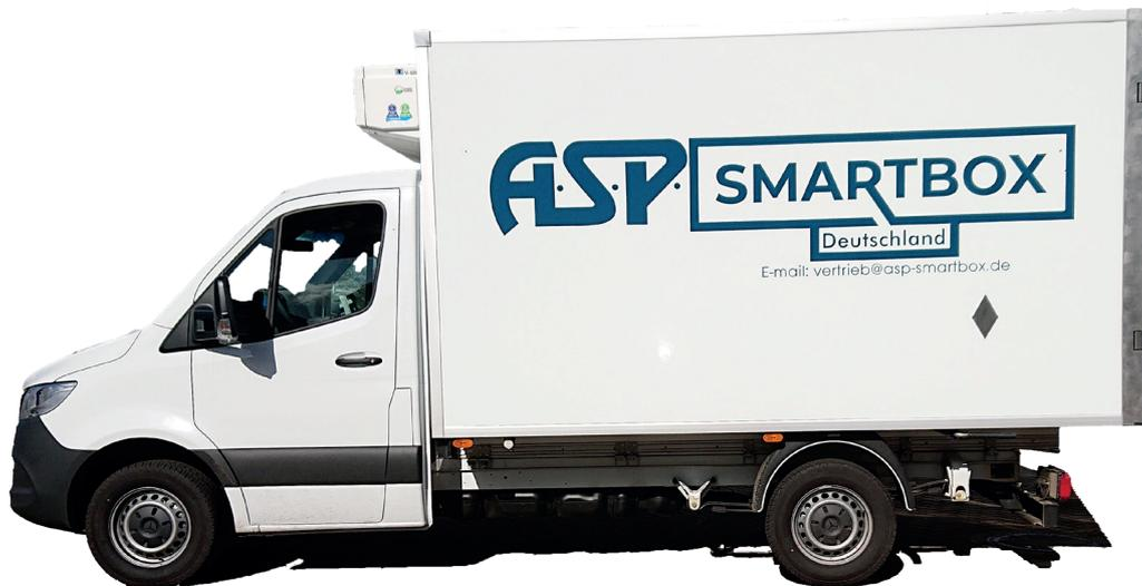
Der SmartBox TO COOL ist ein Leichtbaukühlkoffer, der inklusive Seitentür einen K-Wert von 0,357 aufweist.
